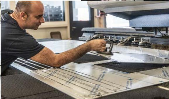
Lasern, stanzen, bohren der Einzelteile beim Nachbarunternehmen, Astromec AG.
